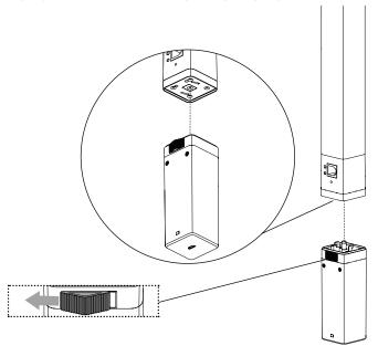
STEP 3 – PUSH TO LOCK BUTTON FULLY TO THE RIGHT TO ENSURE THEY TWO ARE SECURELY ATTACHED.
